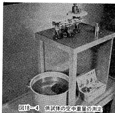
図18-3 供試体の空中重量の測定
