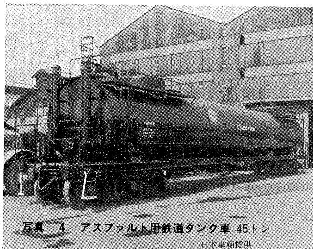
写真-4 アスファルト用鉄道タンク車 45トン
