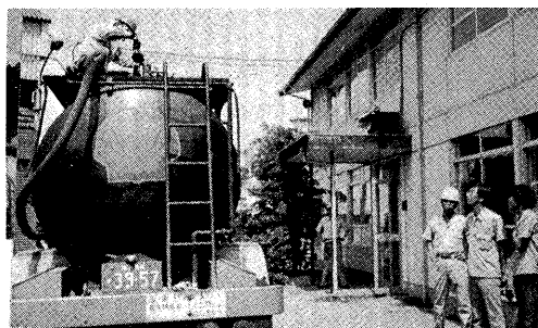
写真-2 アスファルト到着、ローリーより試料を採取する
