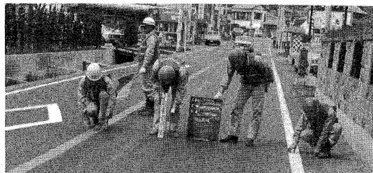
各測定のわだち掘れ深さは、外側車輪通過位置(OWP)および内側車輪通過位置(IWP)の両方をmm単位で求め、大きい方の値（最大わだち掘れ深さ）をとる。
