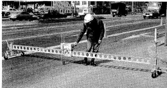
また、写真の装置のように両端支持脚に車輪をつけて、容易に移動出来るようになっているものと、固定式のものとがある。
