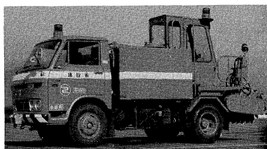
写真-9 路面整正機
