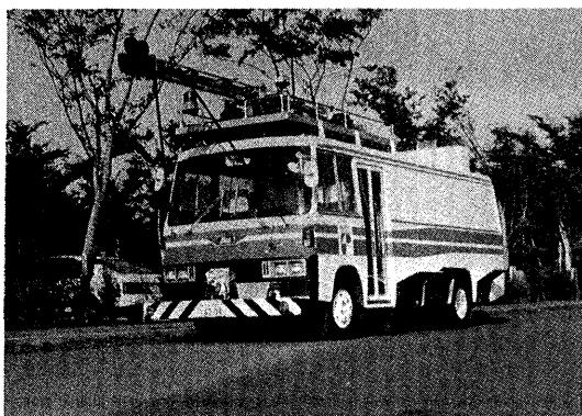
写真-7 わだち掘れ, 縦断凹凸自動測定装置
