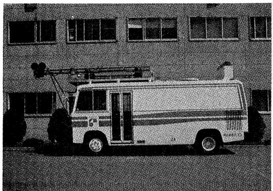
写真-8 ひびわれ自動測定装置
