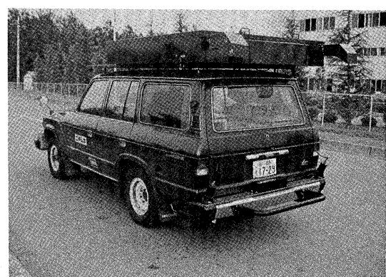
写真-2 わだち掘れ、縦断凹凸自動測定装置
