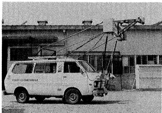
写真-6 わだち掘れ, 縦断凹凸, ひびわれ自動測定装置
