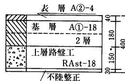
図-2 舗装打換断面図
