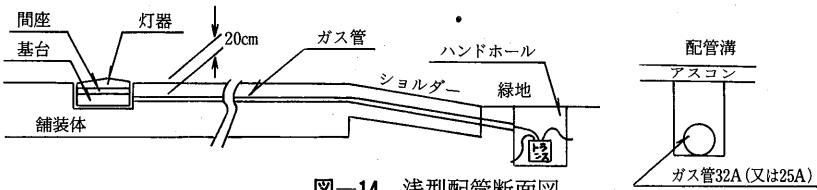
図-14 浅型配管断面図
