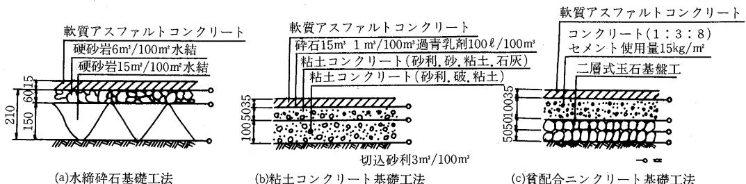
図-3.5.4 軟質アスファルトコンクリート舗装基礎工法の実例<sup>3)</sup>
