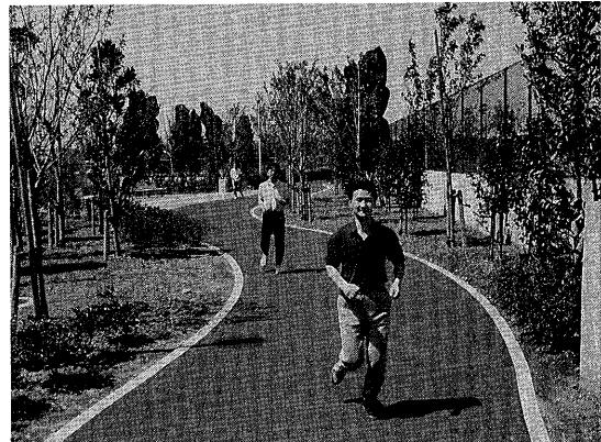
**写真-7** ウレタンゴムチップ系のインターロック式弾性ブロック舗装。二次製品の置き敷きタイプで非常にソフトでデザインの自由度もあり、歩きやすい舗装として幅広い用途に期待される。(千葉市・宮野木スポーツセンタージョギング走路を兼ねた遊歩道)
