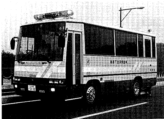
写真－１ 開発された路面下空洞探査車
