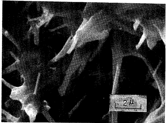
図-3 CAモルタルの結晶組織
