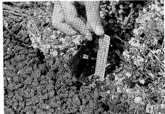
写真-5 排水性表層の下に施工されたSAMI層のアスファルトを引き延ばした状態
