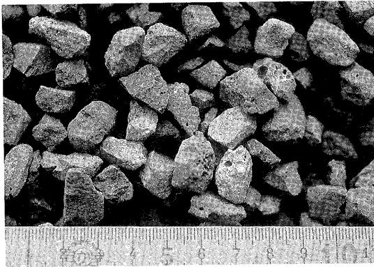
**写真-4 オーストリアで見た排水性混合物用粗骨材、スラグ**
