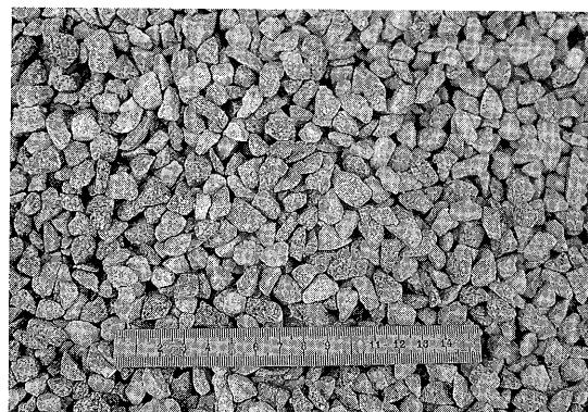
写真-3 ドイツで見た、排水性混合物用粗骨材の外観
