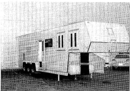
写真-4 移動アスファルト実験室 (混合物試験用トレーラー)
