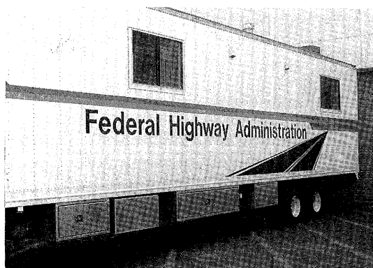
写真-2 移動アスファルト実験室 (バインダー試験用トレーラー)
