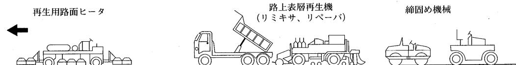
図-1 路上表層再生工法の機械編成
