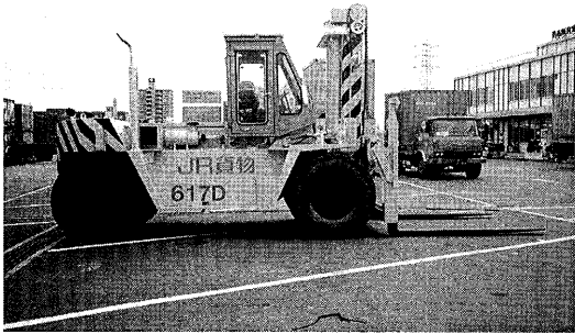
写真-3.4.1 12ftコンテナ用フォークリフトの外観
