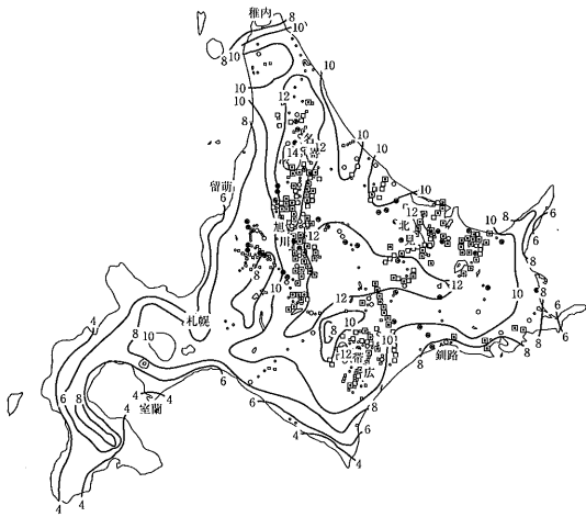
図－1 北海道地区におけるひび割れ発生状況
