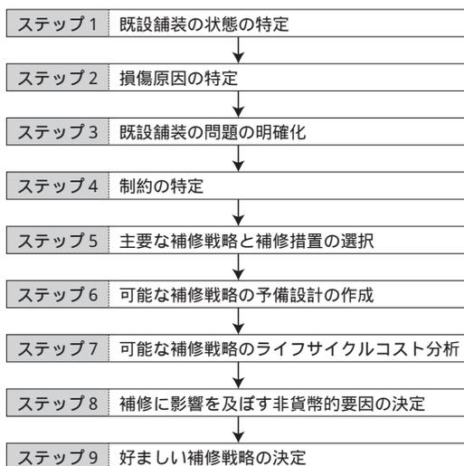
図-25 実行可能な補修戦略を決定するためのステップ
