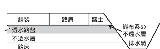
図-12 排水設備を持たない透水路盤
