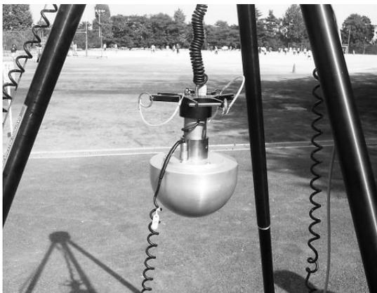
写真 - 8 HIC試験機の測定部（ヘッド）
