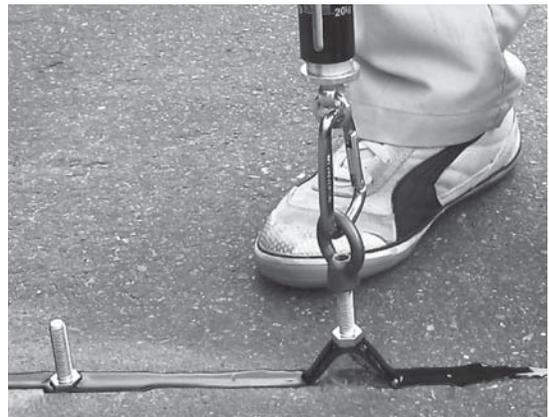
写真-3 ばね式手はかりによる引張接着試験
