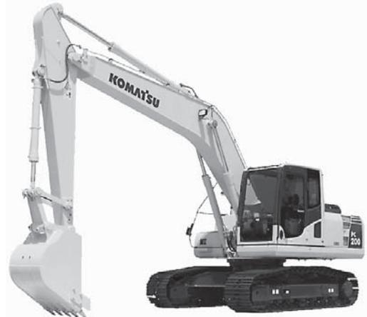
写真-1 超低騒音型建設機械の指定を受けたバックホウの例(写真提供：コマツ)
