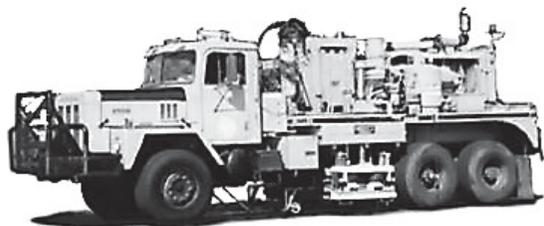
写真-12 Rolling Dynamic Deflectometer<sup>12)</sup>
