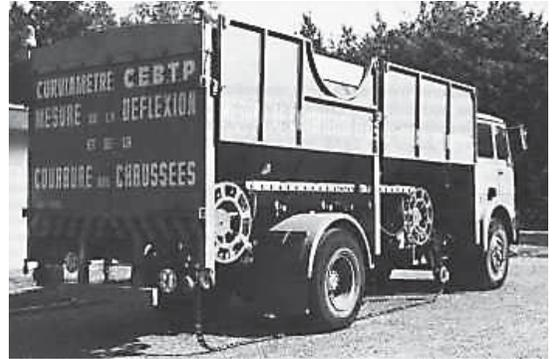
写真-9 Curviameter (Prototype : 1972年)<sup>11)</sup>
