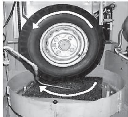
写真-2 ねじり骨材飛散試験
