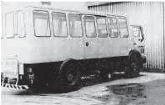
写真-8 英国式舗装たわみデータ収集走行機<sup>11)</sup>
