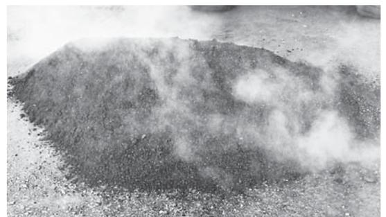
写真-2 製造直後のセミホット型アスファルト混合物(写真の白煙は、水蒸気)
