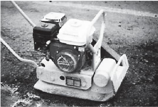
写真-40 振動プレートコンパクタ
