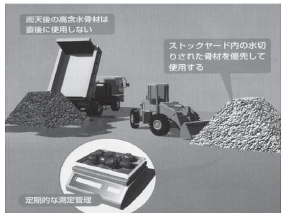
写真-2 使用材料の含水比低減
