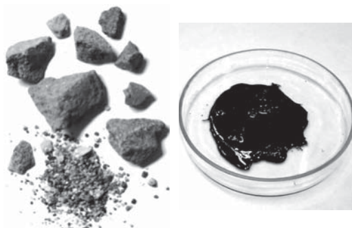
写真-2 回収された骨材とアスファルト
