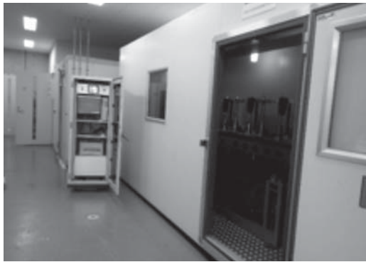
写真-3 3連式ホイールトラッキング試験機
