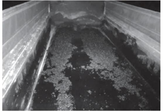
写真-3 ダレが発生し、荷台にアスファルトモルタルや混合物が付着した状況
