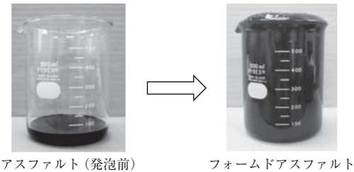
写真－1 フォームドアスファルトの状態
