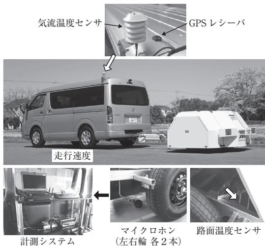
図-6 計測システムの構成
