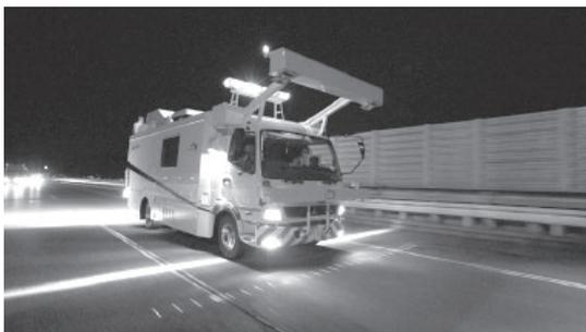
写真-4 路面性状測定車による路面性状調査<sup>21)</sup>
