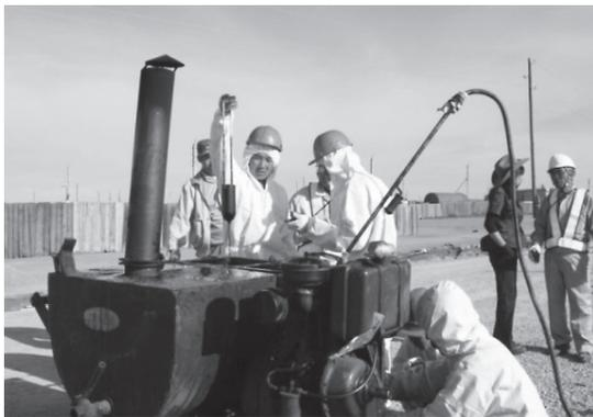
写真-2 カットバックアスファルトの温度粘度測定 碎石
