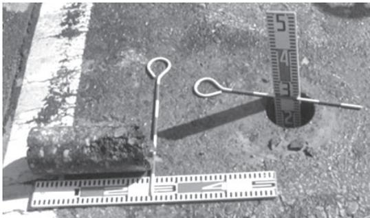
写真-3 開削調査，コア採取による評価<sup>20)</sup>
