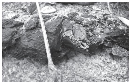
写真-6 防水材 No.5の破断面 (光沢断面)
