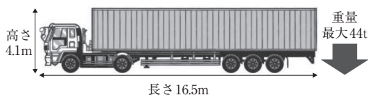
図-1 国際海上コンテナ車(40ft背高) 3)
