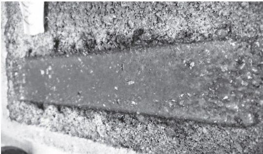
写真-6 PEs-A 添加 水浸 WT 試験後供試体外観
