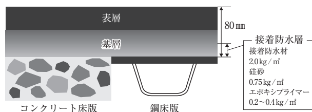
図-1 RA工法の舗装断面
