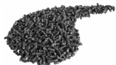
写真-10 セルロース繊維を用いた木質ペレット 10)
