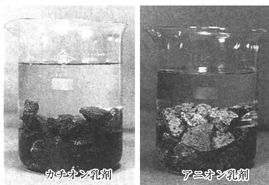
写真-2 水中における骨材への付着状況
