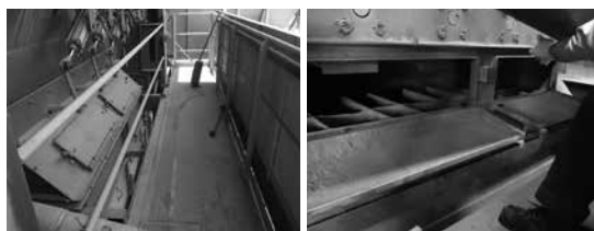
写真-1 対象国にある日本製APでの ホットビン採取口
