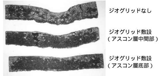
写真-18 200,000回載荷後の切取供試体
