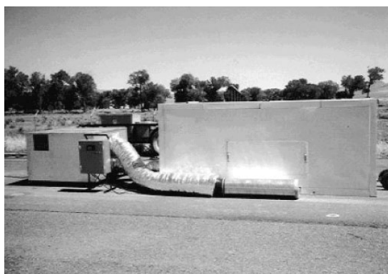
写真 - 32 MMLSの環境制御槽 34)
