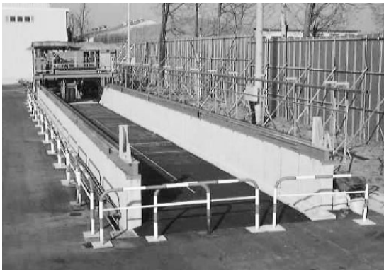
写真-20 ロードシミュレータ（全景）
